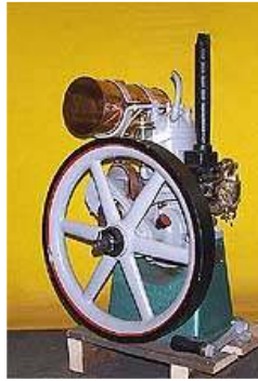
Solo motor G3 Stationär 2 hk. Tillv. 1934
